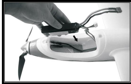
Akku im Rumpf einsetzen sowie das auswiegen gehören in einen Arbeitsgang. Ist der richtige Schwerpunkt gefunden kann der Akku mit Klettband im Rumpf befestigt werden
