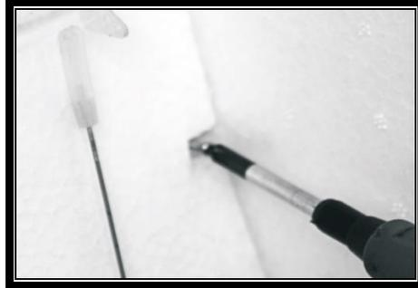
Hängen Sie bei diesem Arbeitsgang gleich die Anlenkung mit ein.
