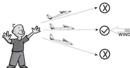
Den Gasknüppel in Vollgasposition stellen und das Modell parallel zum Boden aus der Hand leicht heraus werfen.
