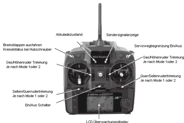
**Wählen Sie mit dem Schalter auf der Rückseite zwischen Mode 1 oder 2.**
