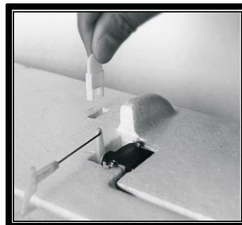
Schieben Sie die Flächenhälfte von einer Seite in den Rumpf. Die andere Flächenhälfte wird von der anderen Seite aufgeschoben. Beide Kabel der Querruderservos müssen dabei in den Rumpf geführt werden und am Empfänger angeschlossen werden. Zweiten Haltclip einsetzen.
